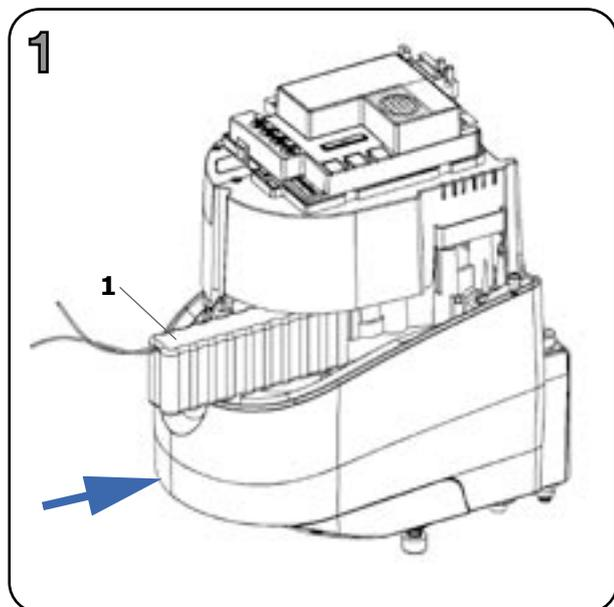
Placer la batterie (1) dans l'emplacement prévu à cet effet.
